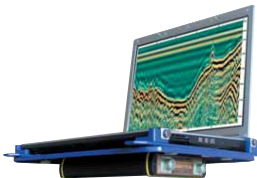
Ноутбук и блок управления (внизу), закрепленные на подвеске
